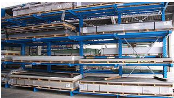
Foto N°6: Sistema de Almacenaje de marcos de Aluminio para ventanas prefabricadas
