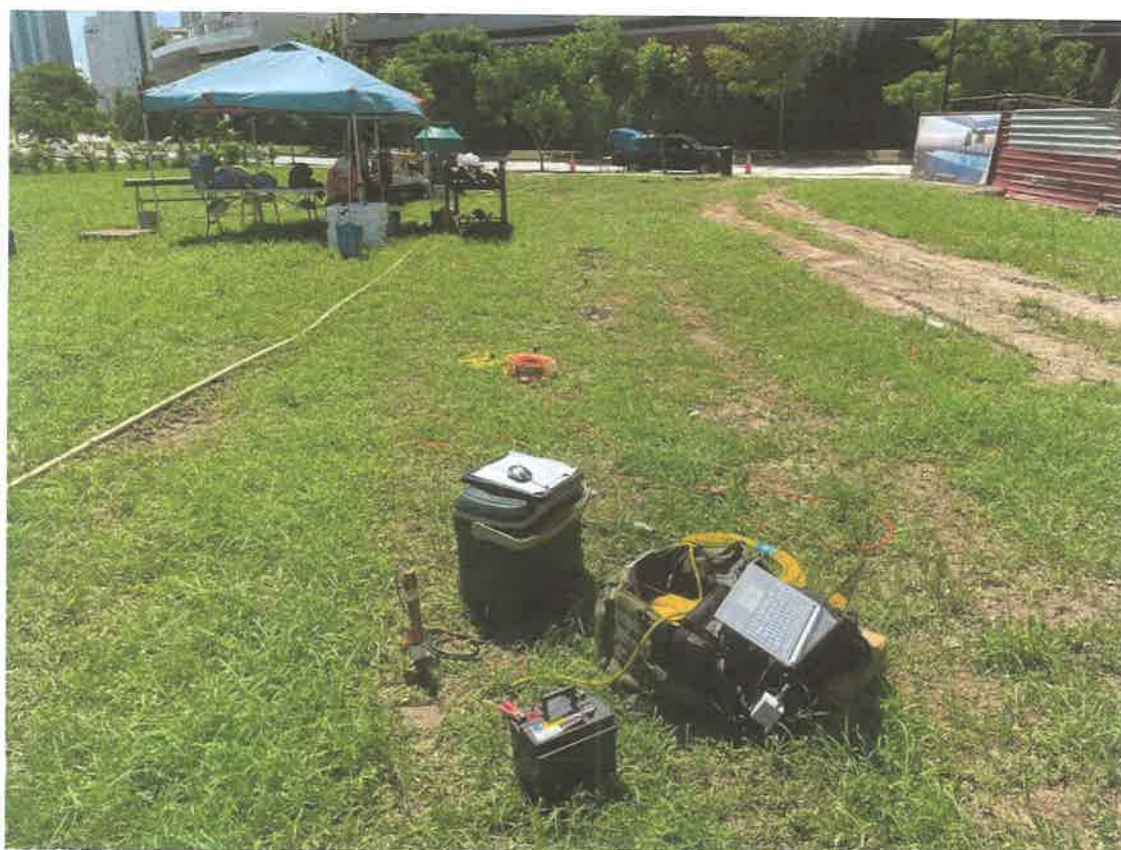
Fotografía Nº 2.2.1: Sismógrafo GEODE 24-Channel SEISMODULE (Geometrics, Inc.)
