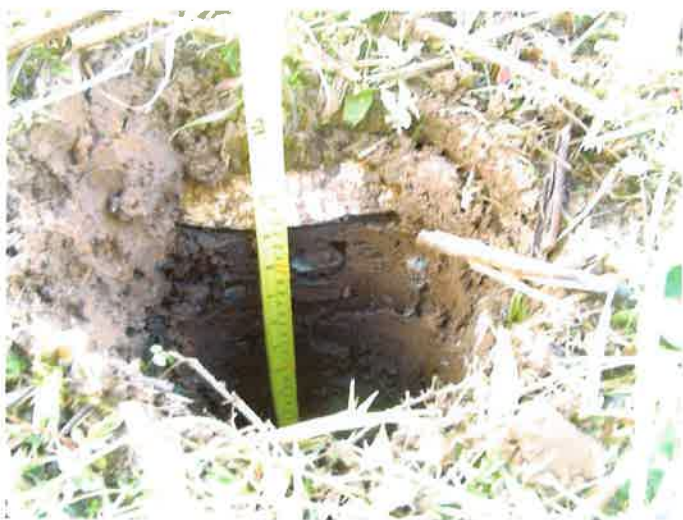
Detalle de la estratigrafía del área de estudio. Pueden observarse evidencias del relleno reciente, como desechos plásticos (UTM 661510E/997339N).
