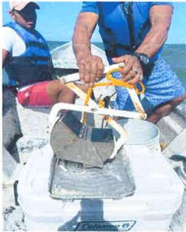
Ilustración 1. Draga con un mínimo de sedimento fino insuficiente para el laboratorio.
