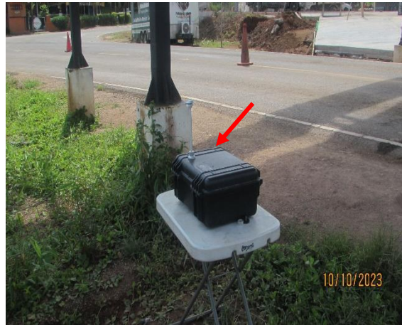
Imagen 5. Vistas del equipo durante la medición de PM_{10} en el Punto 1. Puesto de Control
