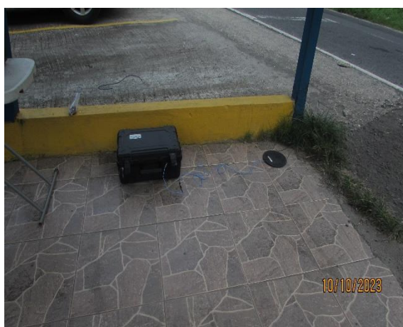
Imágenes 14.10.1 y 14.10.2. Equipo utilizado para medir vibraciones. Punto 1 y Punto 2, respectivamente
