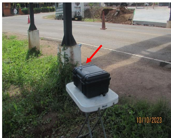
Imágenes 14.8.1. Vistas del equipo durante la medición de PM_{10} en el Punto 1. Puesto de Control
