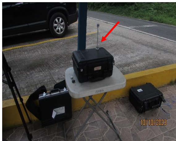
Imagen 14.8.2. Vistas del equipo durante la medición de PM_{10} en el Punto 2. ULAPS CSS Portobelo
