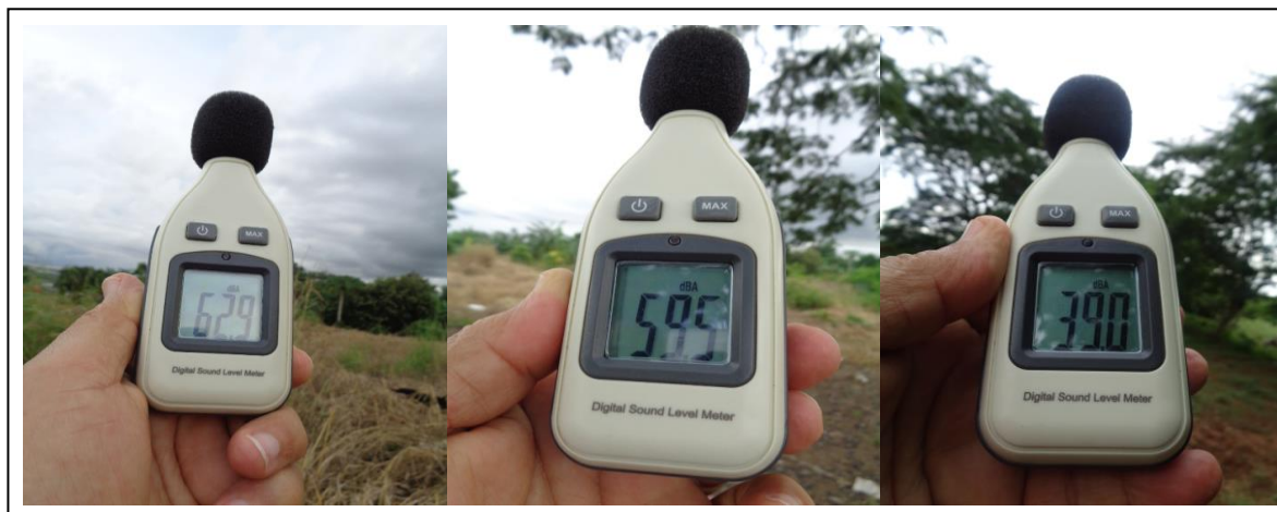
FIGURA 3 – Vistas que ilustran el registro de las mediciones de ruido efectuadas. (Sáez 2017)
