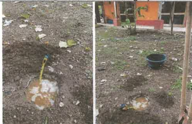
HOYO DE PRUEBAS DE PERCOLACIÓN (Medición del nivel de agua)
