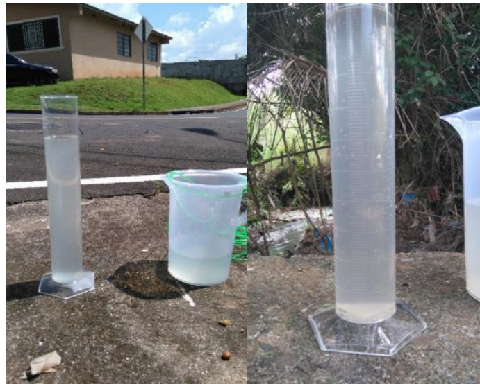
Foto 7: Ensayo de Sólidos Sedimentables en Sistemas de Alcantarillado Existente
