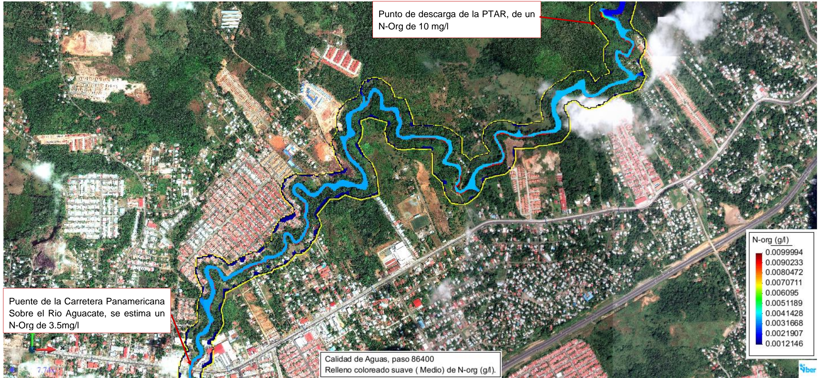
Figura 16 – Resultados del N-Org a lo largo del Rio Aguacate Época de Invierno.
