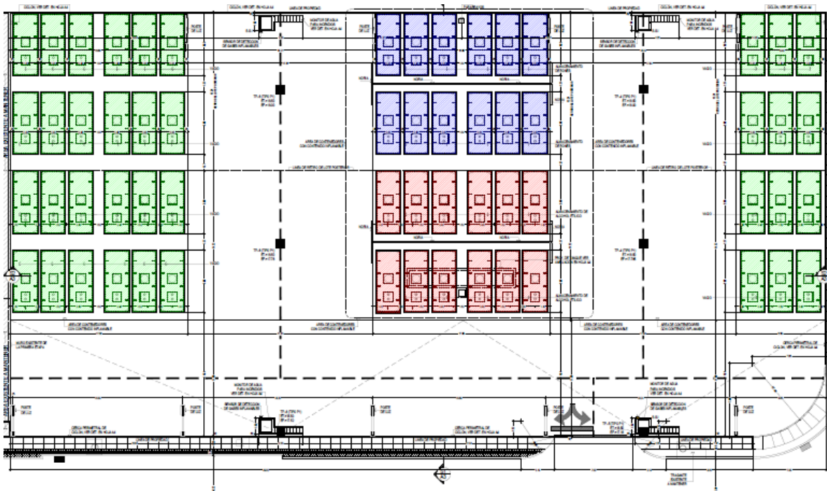
Figura 4. Vista de Planta Arquitectónica del patio con la ubicación de los tanques vacíos (color verde) y tanques con ron (azul) e alcohol etílico (rojo)
