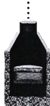
Pozo de filtración
