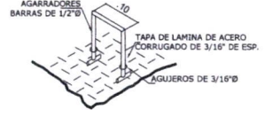
DETALLE DE AGARRADERO DE TAPA R-2 SIN ESCALA
