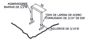
DETALLE DE AGARRADERO DE TAPA R-2 SIN ESCALA
