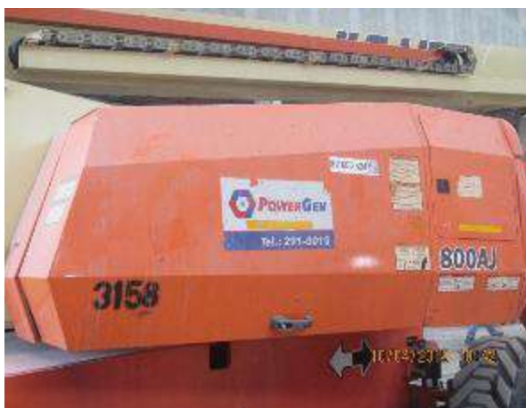
Imagen 63. Manlift con código 82600324 sin registro de inspección mensual
