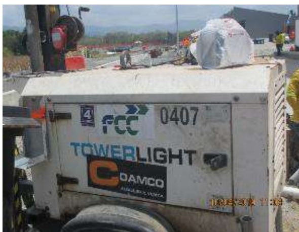
Imagen 67. Planta eléctrica sin sticker mensual y sin batería
