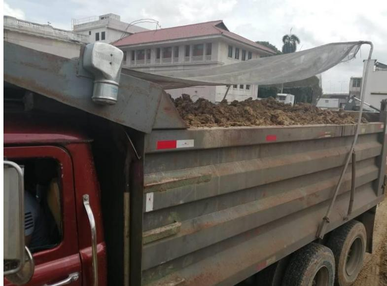
**Fotografía No. 3:** Los camiones que transportan el material terreo, utilizan lonas protectoras.
