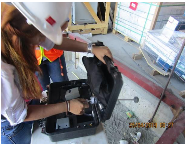
Imágenes 2.1.1 y 2.1.2. Equipo de medición durante el monitoreo de PM 10
