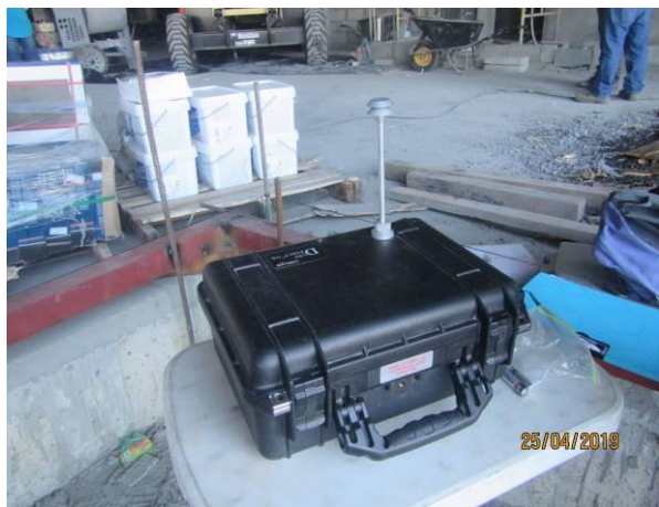
Imágenes 2.1.1 y 2.1.2. Equipo de medición durante el monitoreo de PM 10
