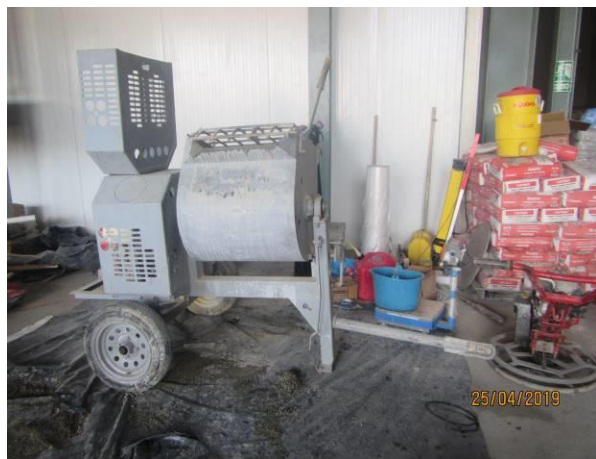
Imágenes 2.1.3 y 2.1.4. Fuente generadora de partículas: mezcladora de concreto
