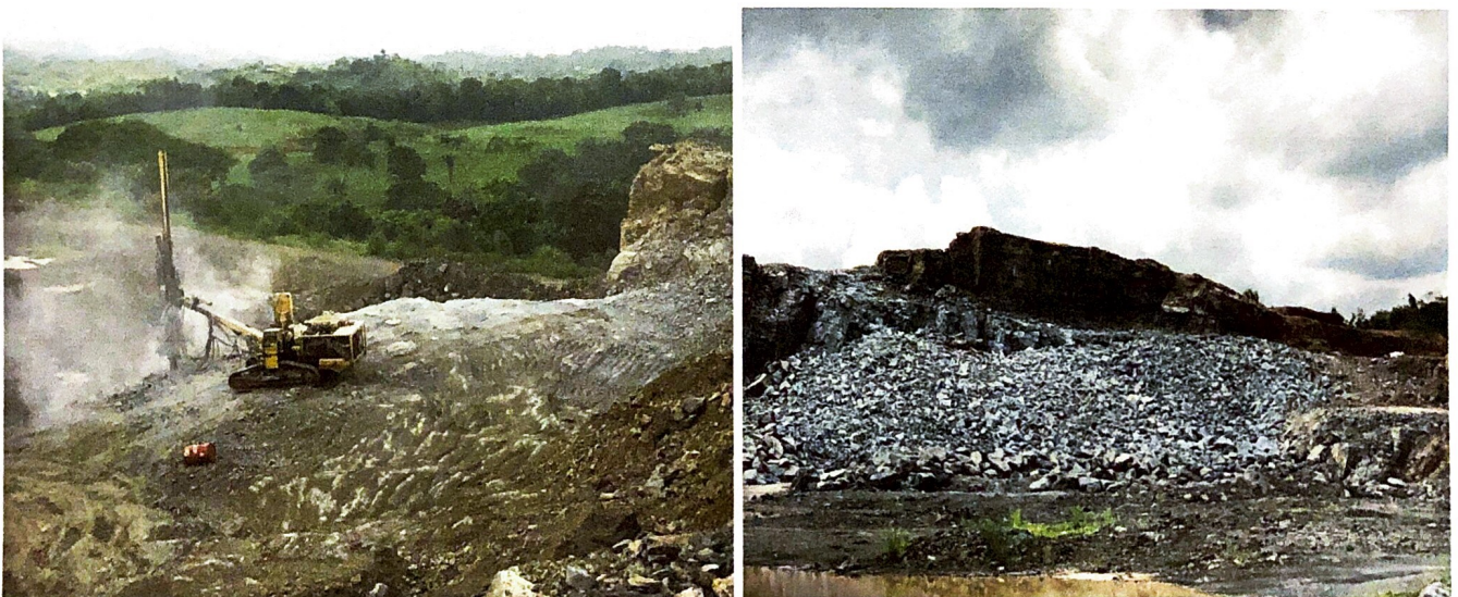
Imagen 1. Operación de Perforación del macizo de roca basáltica
