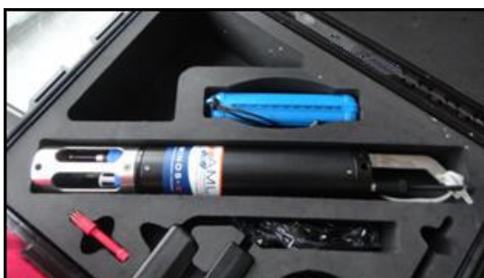
Imagen 18. AML perfilador de velocidad del sonido.
