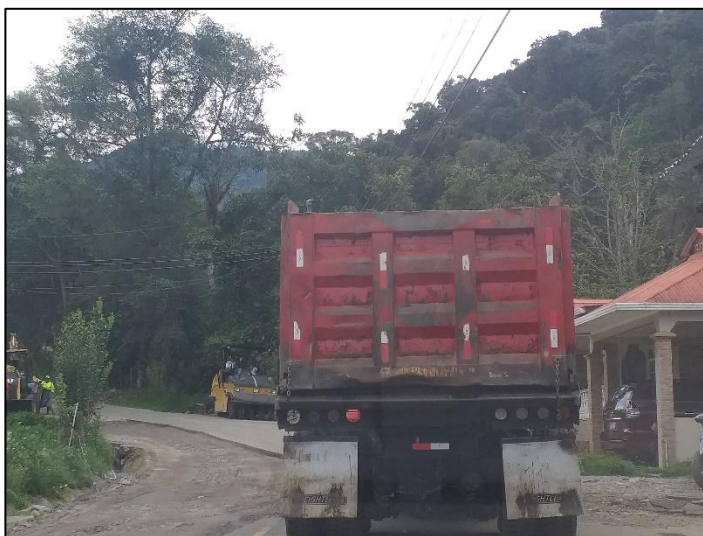
Fotografía N°67-70. Camión de carga portando lona y polleras de seguridad
