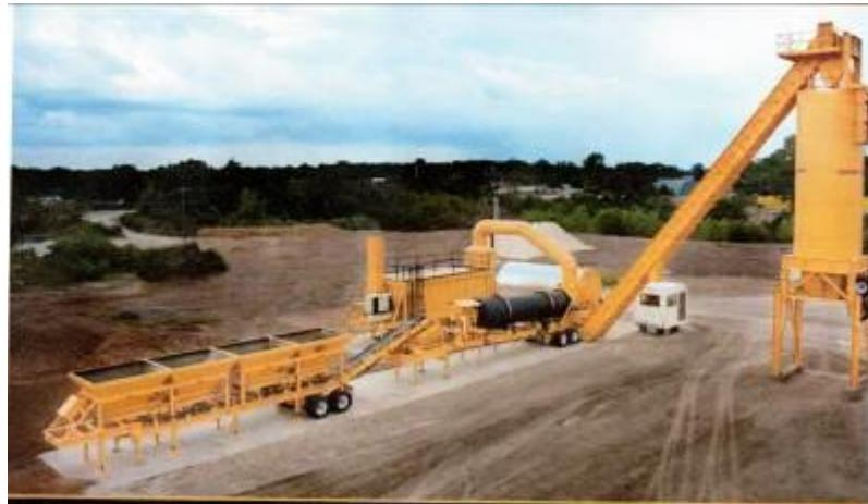
Esta planta cuenta con una capacidad tope de producción de 130 toneladas de asfalto por hora y se trata de una planta con caza de filtro o sea que no utiliza agua para la captura de polvo y agregados pequeños que son atrapados en el filtro y luego con inyección de aire a presión son incorporados a la tolva de mezclado por medio.
