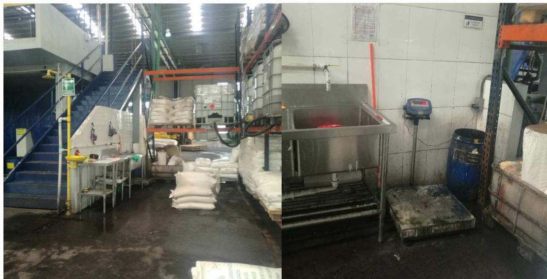
Foto 23-24. Área contigua a los bombos donde se hace manejo estacional de químicos. Se mantiene un estante donde se ubican los productos, pesa, herramientas, EPP, ducha de emergencia y solución lavaojos.
