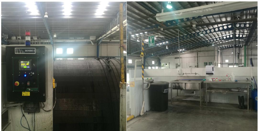
Foto 21-22. El área de bombos ha sido digitalizada, cuenta con botón de emergencia, alarma y registro del proceso. Ducha de emergencia, lavaojos, mesas de trabajo
