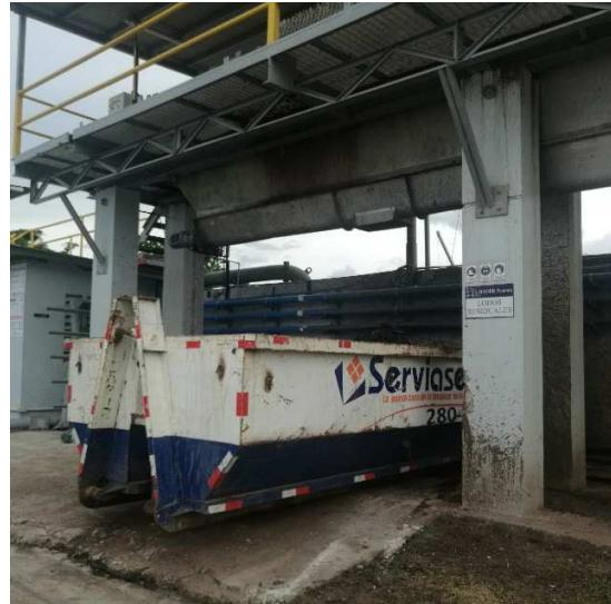
Foto 79. Volqueta de 15Yds en la cual se recogen los lodos.
