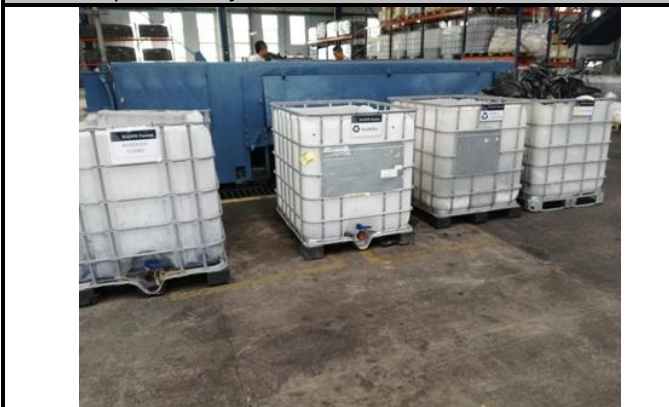
Foto 3. Tanques IBC reciclados dentro de la planta. Los mismos son utilizados para la clasificación de los desechos.
