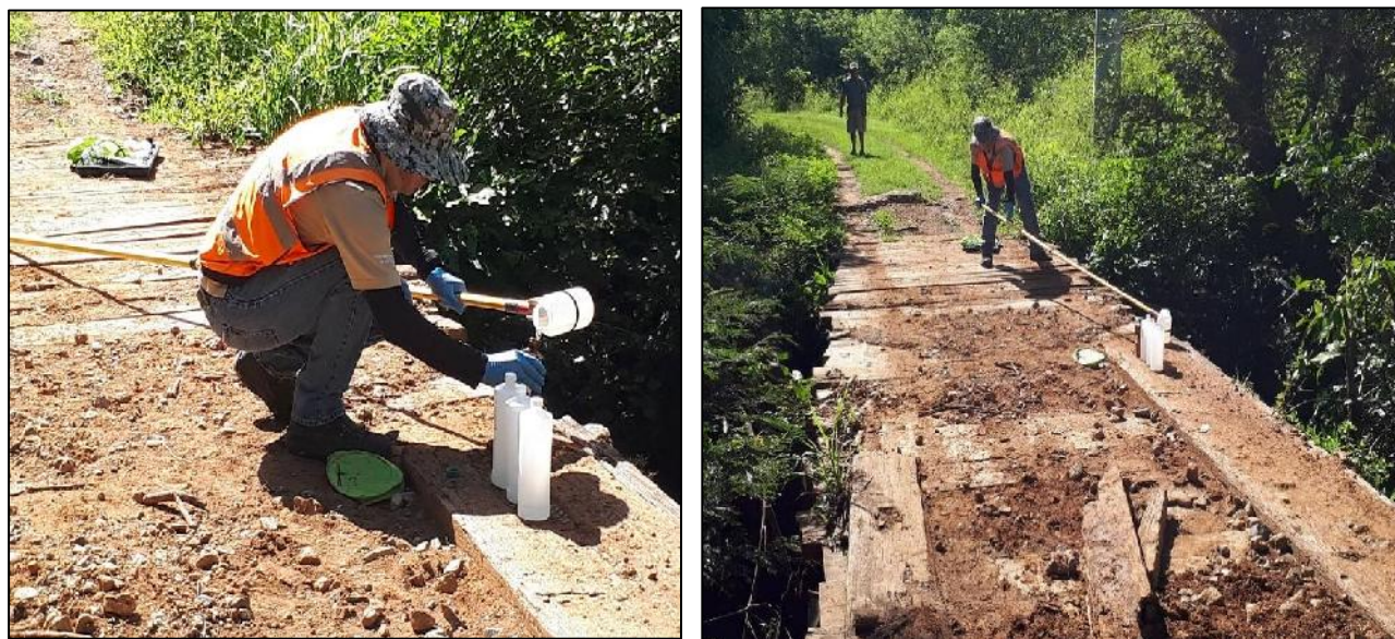
Figura 9. Toma de Muestras de agua por personal del Laboratorio EnviroLAB
