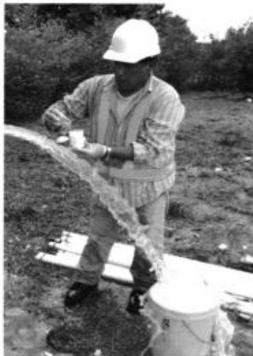
Fig.32, 33- Toma de muestra para análisis físico-químico completo y bacteriológico de laboratorio en el pozo PP1 (proceso de enjuague de recipientes y toma) – proyecto Urbanización Santamaría
