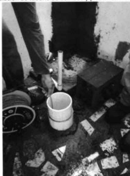
Fig.16- Proceso de medición de niveles de recuperación en el pozo PP1
