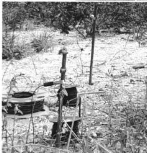
Fig.21-Colocación de Electrodo y cableado in situ en el punto central (PC) de uno de losSEVs
