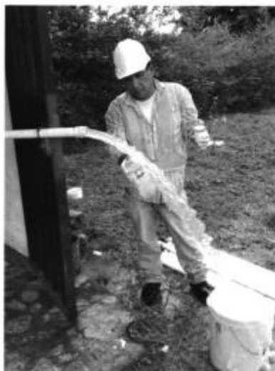
Fig.32, 33- Toma de muestra para análisis físico-químico completo y bacteriológico de laboratorio en el pozo PP1 (proceso de enjuague de recipientes y toma) – proyecto Urbanización Santamaría
