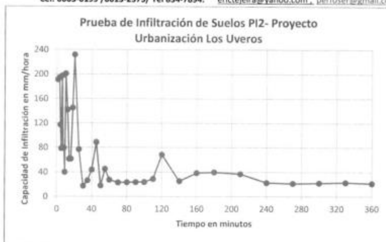
Fig.24- Prueba de infiltración de suelo (PI-2), F_c = 21.92 \text{ mm/hora}
