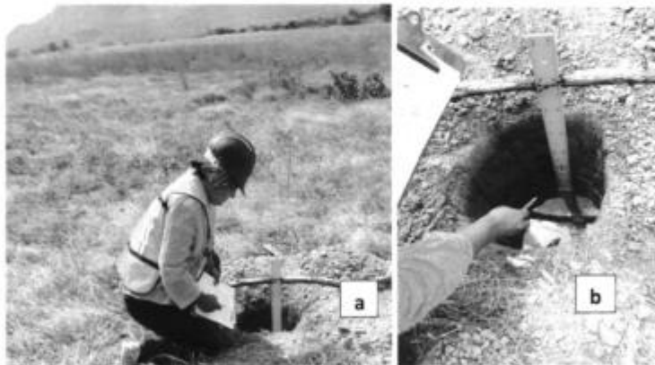
Figura 28 (a,b)- Realización de prueba de infiltración de suelos PI2- con el método de Porchet- Proyecto Urbanización Los Uveros
