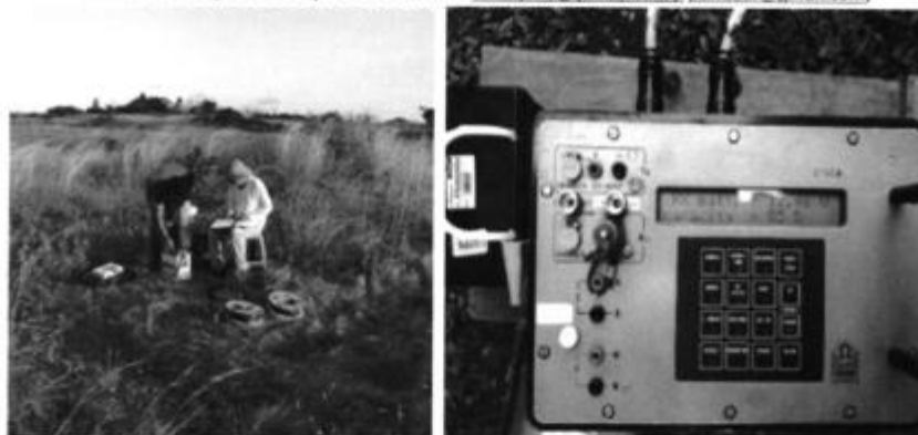
Figs. 18 y 19 : Localización del centro de uno de los SEVs y Toma de datos mediante el dispositivo Syscal.
