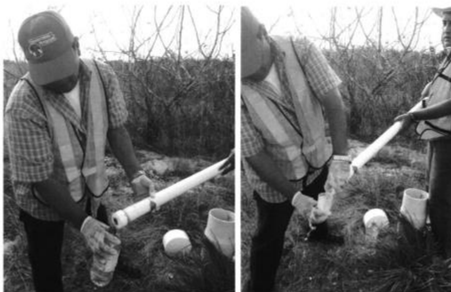
Figuras 35 y 36- Toma de muestras para análisis de calidad del agua fisicoquímicos y bacteriológicos de laboratorio en el pozo PP5 (comunidad El Silencio).
