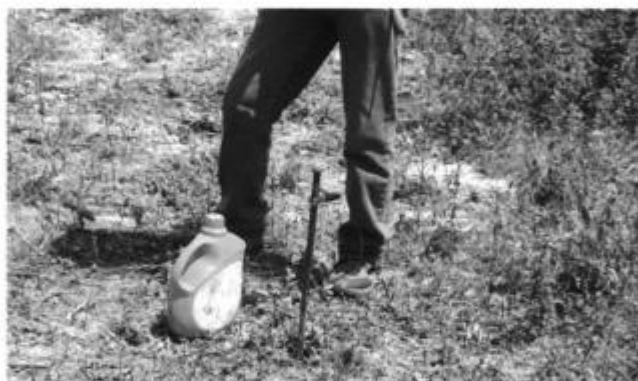
Fig.22-Vista de trazado y cableado en uno de los electrodos laterales de SEV1, situado a unos 70 metros al suroeste del centro del SEV1
