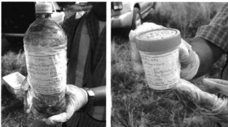
Figuras 37 y 38- Etiquetado para muestras de análisis de calidad del agua físico-químicos y bacteriológicos de laboratorio en el pozo PP5, (aunque en la etiqueta se marcó como PP4 por la secuencia del inventario el código es PP5(comunidad El Silencio)).
