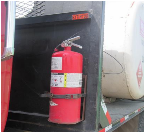
Foto 222-223: Vigilar que los equipos pesados y las áreas que lo requieren mantengan los extintores en sitio.
