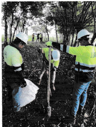
MUESTREOS DEL SUELO EXISTENTE PARA ENSAYOS DE CBR
