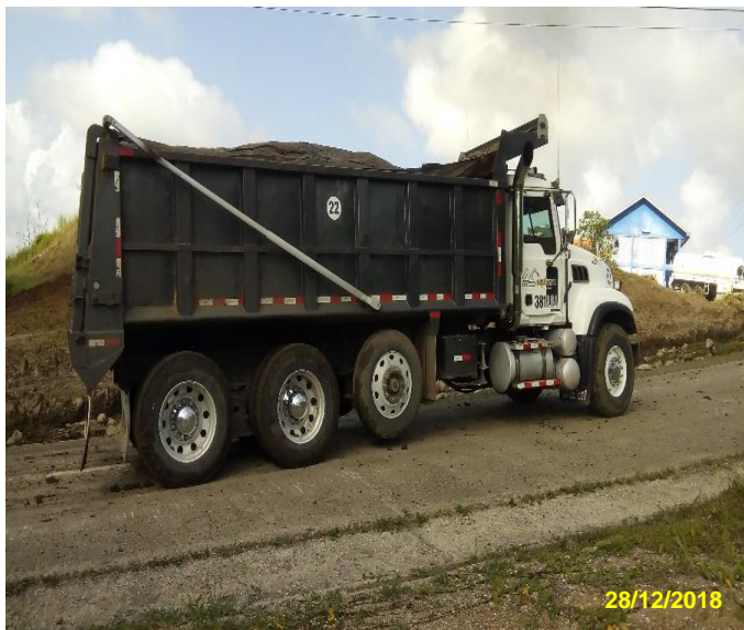
Foto No.2. Colocación de lona en equipos que realizan acarreo de materiales para controlar caídas de estos en las vías.
