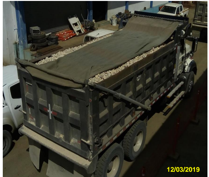
Foto No.2. Colocación de lona en equipos que realizan acarreo de materiales para controlar caídas de estos en las vías.
