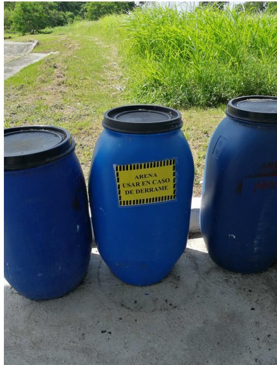
Foto 6. Dentro del área se mantienen tanques con arena y tanques para la disposición de desechos oleosos en caso de fuga accidental o derrame.
