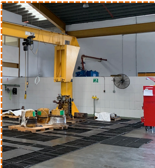
Área de desarmado de partes, con sistema de captación de aceites, herramientas y dispositivos de seguridad, debidamente señalizada y ventilada,
