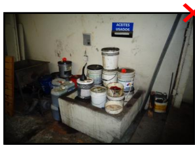
Tanques con aceite usado almacenado fuera de la tina de contención.
