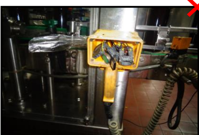
Se observó que botones de control de la máquina lavadora se encuentran expuestos. Se debería colocar una tapa protectora.
