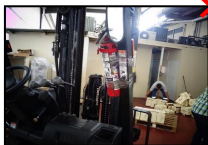
Se observó que el soporte del extintor de la montacargas del área de armado de cajas no es el adecuado, en una emergencia puede causar problema y pérdida de tiempo.
