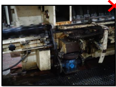
Se evidenció que existe riesgo al manipular la máquina lavadora, el operador puede sufrir atrapamiento de sus extremidades, varias cadenas expuestas.
