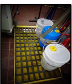
Pallet de contención de derrame lleno con agua. Se encuentra próximo a desbordarse.
