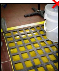
Pallet de contención de derrame lleno con agua. Se encuentra próximo a desbordarse.
