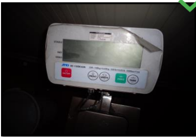
Balanza con su tarjeta de calibración visible y dentro del periodo de vigencia de calibración
