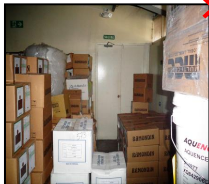
Se evidenció que la salida de emergencia estaba obstruida por cajas , en una emergencia esto es sumamente grave.
