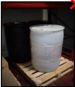
Tanques con sustancias químicas deben ser almacenados en pallets de contención anti derrame.
