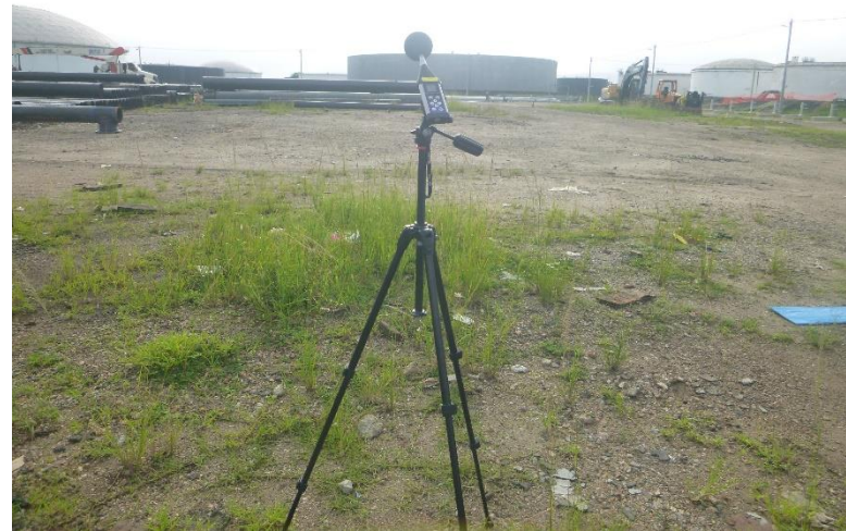
Fotografía 6: Medición de ruido en punto 2 – Área de Botadero.
