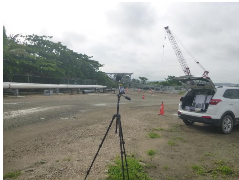
Fotografía 10: Medición de ruido en punto 4 – Muelle norte.
