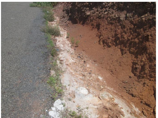
Restos de agua de lavado de concretera vertida en la cuneta y en el terreno.
