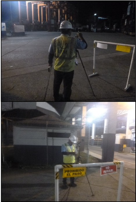
Fotografía 6: Medición nocturna de Ruido Ambiental en Punto 3, localizado en la garita de seguridad de entrada de camiones.
