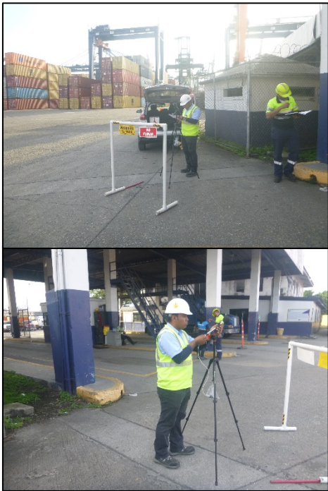
Fotografía 5: Medición diurna de Ruido Ambiental en Punto 3, localizado en la garita de seguridad de entrada de camiones.
