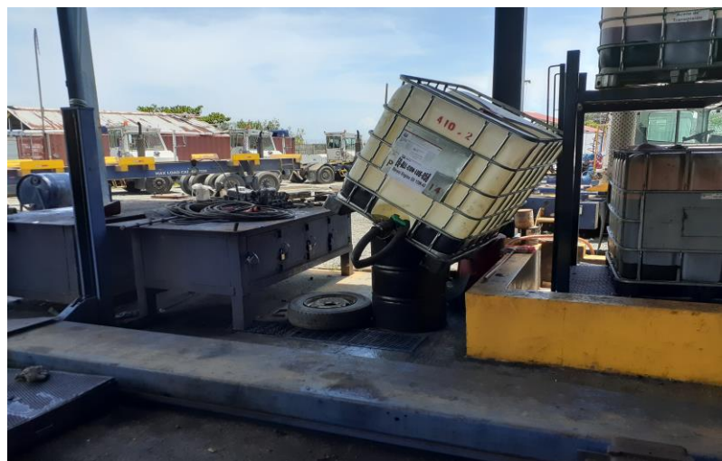
4. Manejo inadecuado de Tanques de almacenamiento, área de Taller.
