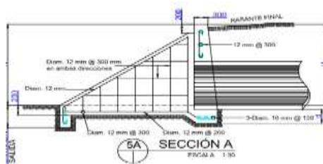
Acero de refuerzo para cabezal
