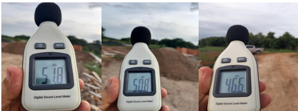
FIGURA 4 – Vistas que ilustran el registro de las mediciones de ruido efectuadas. (A. Sáez 2019)
