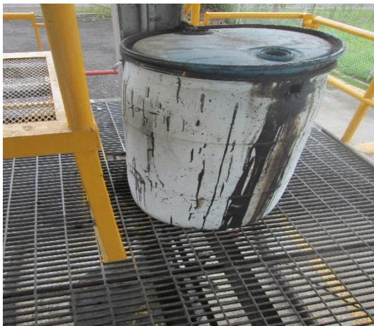
Imágenes 7 a 10. Ausencia de medidas de contención.
