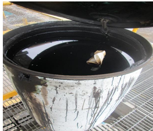
Imágenes 7 a 10. Ausencia de medidas de contención.
