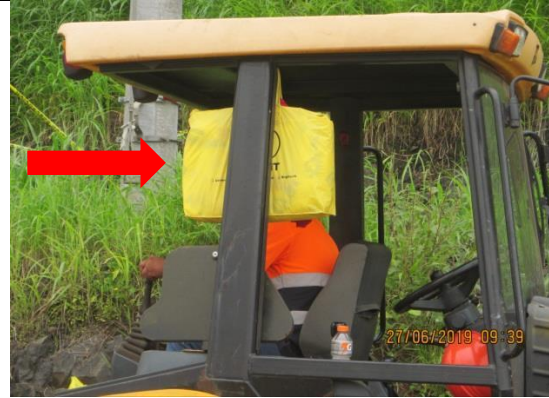
Ilustración 17. Los equipos utilizados en el proyecto cuenta con el kit contra derrame de hidrocarburos.
