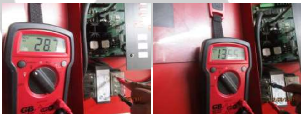
Fig. 2 y 3 – Voltaje de panel de servicio industrial (135.6V/28.8V)
