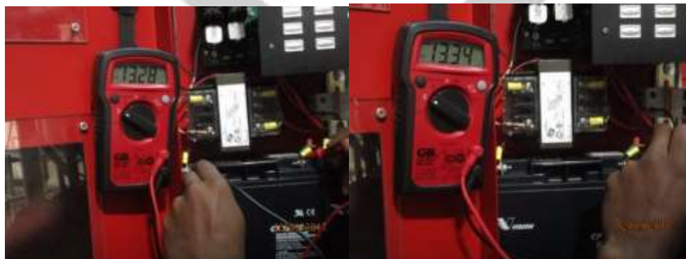
Fig. 4 y 5 – Voltaje de baterías. (13.28V/13.34V)
