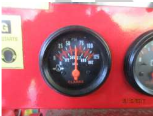
Fig. 5 – Estado y Presión de Aceite del Motor 65 PSI
