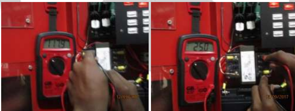
Fig. 4 y 5 – Voltaje de baterías. (13.28V/13.34V)
