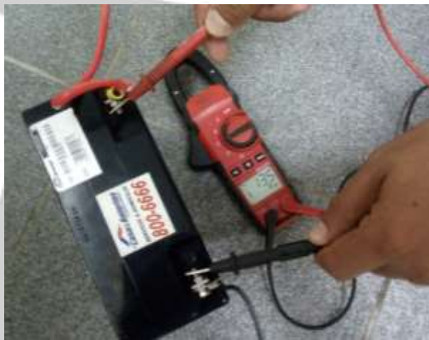
Fig. 5 – Verificación de voltajes de baterías del panel.
