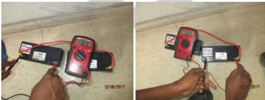
Fig. 4 y 5 – Voltaje de baterías. (13.65V/13.68V)
