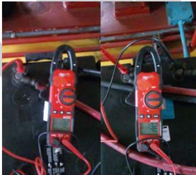
Figs. 4 - Verificación de Voltaje de las Baterías ambas en 13.2 V
