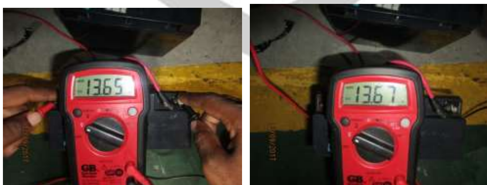
Fig. 4 y 5 – Voltaje de baterías. (13.65V/13.67V)
