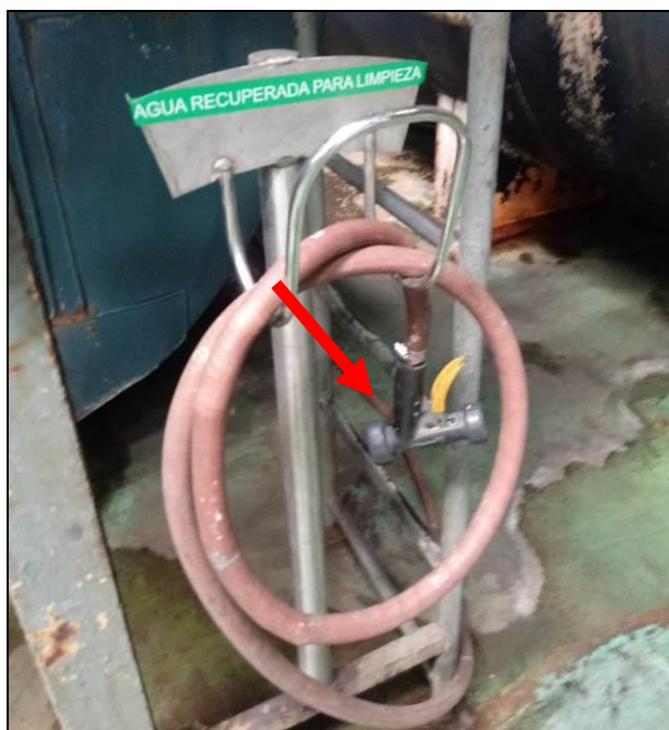
Fotografía No. 2: Sistemas de cierre automático en mangueras de limpieza.
