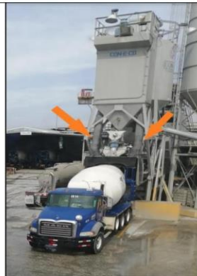
Foto 3: la planta de fabrica en el punto de carga de camiones, cuenta con un equipo colector de polvo con sus respectivas mangueras de succión a ambos lados.
