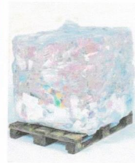
El fardo de los residuos compactados se coloca sobre una parihuela con la ayuda de un apilador quedan lista para ser recogidas.
