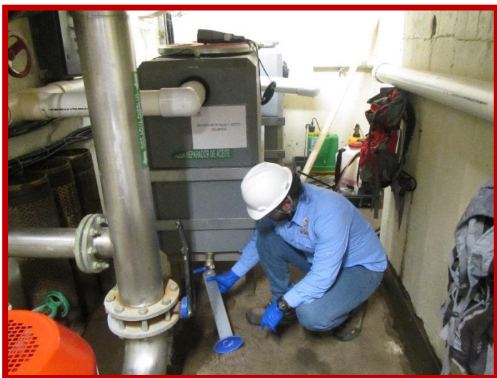
Fig.12. Recolecta de muestra en el sitio identificado como separador de agua y aceite
