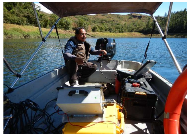
Fig. 6 Bote de fibra de vidrio con equipo batimétrico ECOSONDA DIGITAL DE FRECUENCIA SINGULAR SOUTH SDE-28S
