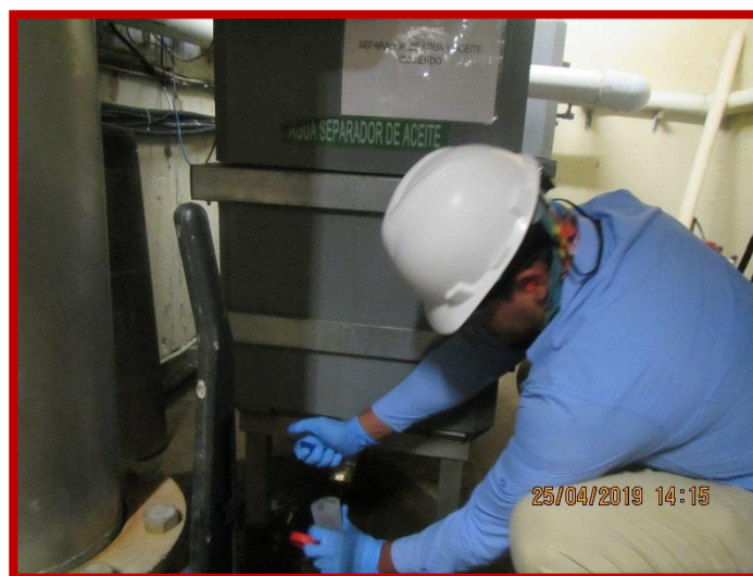
Fig.3. Recolecta de muestra en el sitio identificado como separador de agua y aceite izquierdo
