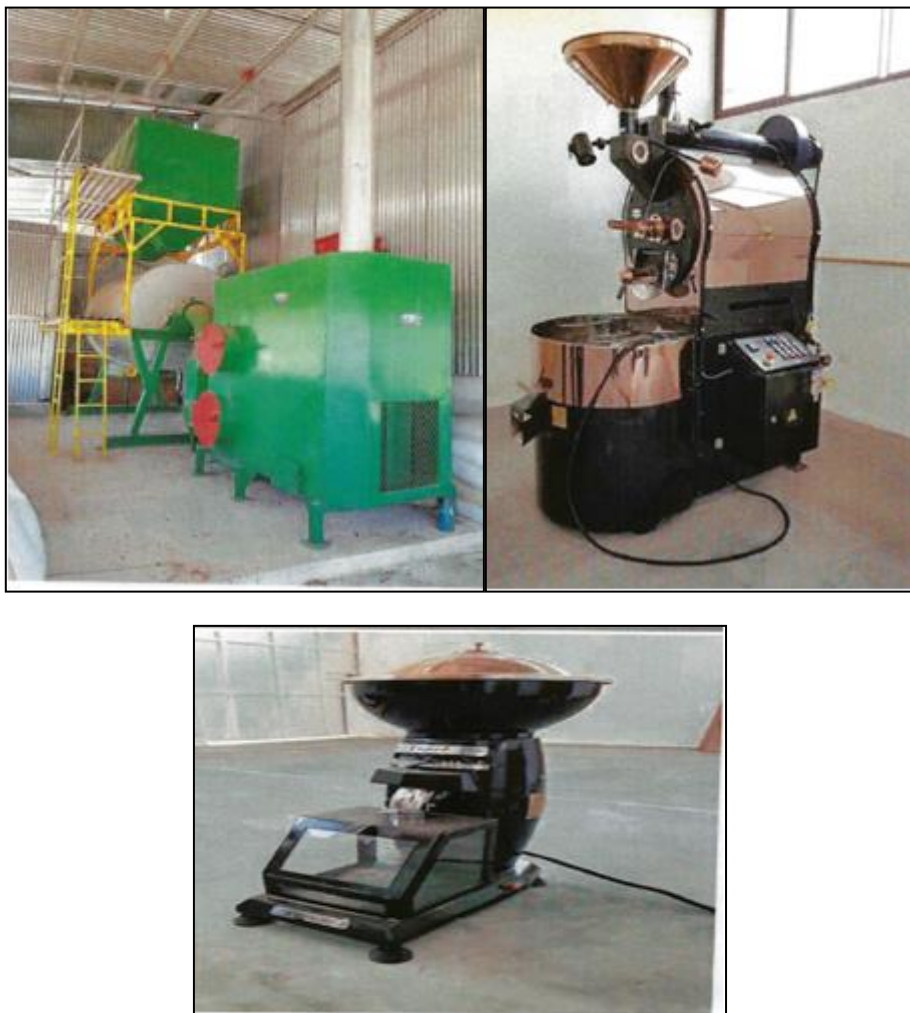
Figuras N° 3-5. Equipo por utilizar para el procesamiento del café, secadora, tostadora, molino.
