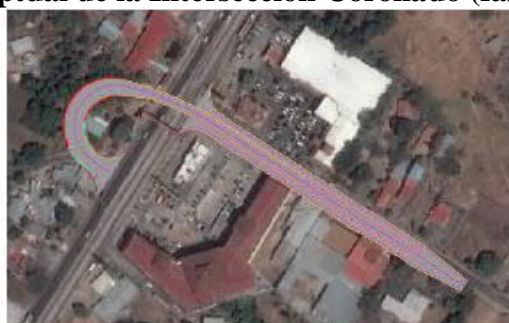
Figura 5-6 Esquema conceptual de la Intersección Coronado (fase de pre-diseño)
