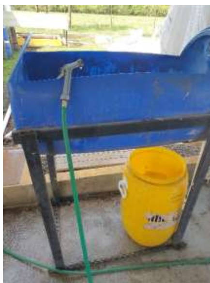
Fotografía No. 31: Mangueras con dispositivos de interrupción de cierre automático.
