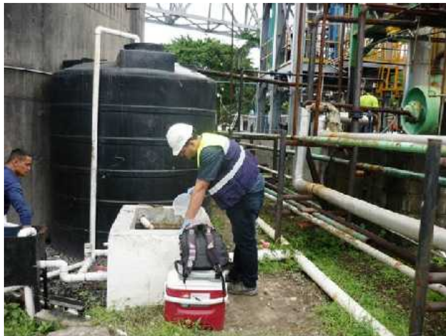
Captación de muestra de aguas residuales del proyecto para ser sometidas al monitoreo de la calidad de las aguas.
