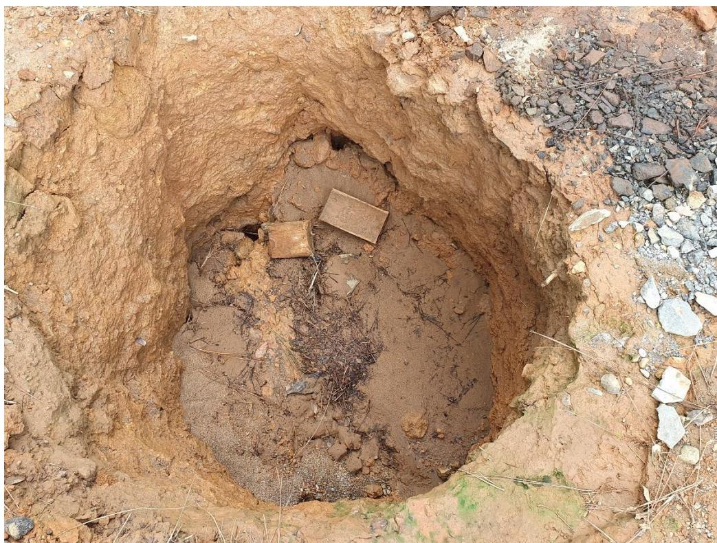
Foto No. 6.3-2. Hoyo formado aparentemente por corrientes subterráneas.
