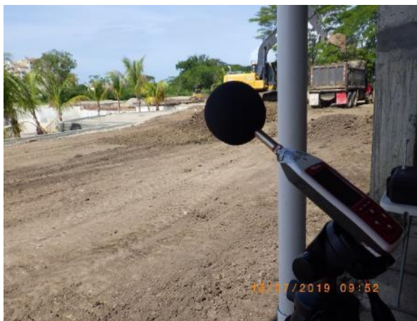
Imágenes 1 y 2. Equipo de medición de ruido ambiental y fuente de ruido identificada (movimiento de equipos pesados) en el lugar de medición (frente al edificio 200)
