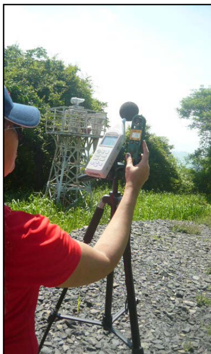
Se observa el instante en que se tomaban los parámetros ambientales con un anemómetro, en el punto RPV-1 durante la medición de ruido ambiental.
