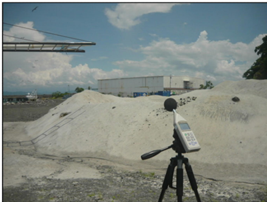
Se observa en esta fotografía el monitoreo de ruido ambiental efectuado en el sitio RPV-1
