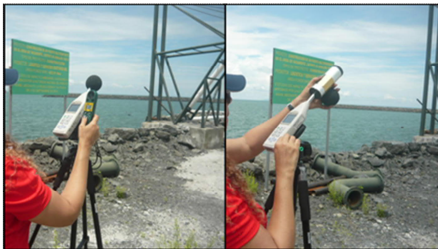
Observamos el momento en que se efectuaba la calibración del equipo de medición y la toma de parámetros ambientales en el sitio RPV-1.
